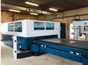
Разделение листового металла при помощи лазера
