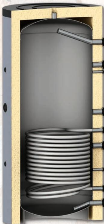
Объем аккумуляционного бака для хорошего функционирования котла рекомендуется 40 - 80 л на 1 kW подключенной мощности котла.
