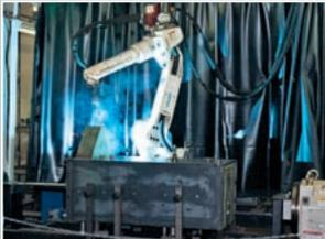
Роботизированное сварочное производство с ЧПУ управлением
