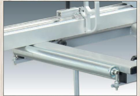
Ролик опорной рамы
