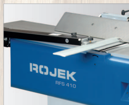
Защитный кожух ножевого вала CPS
